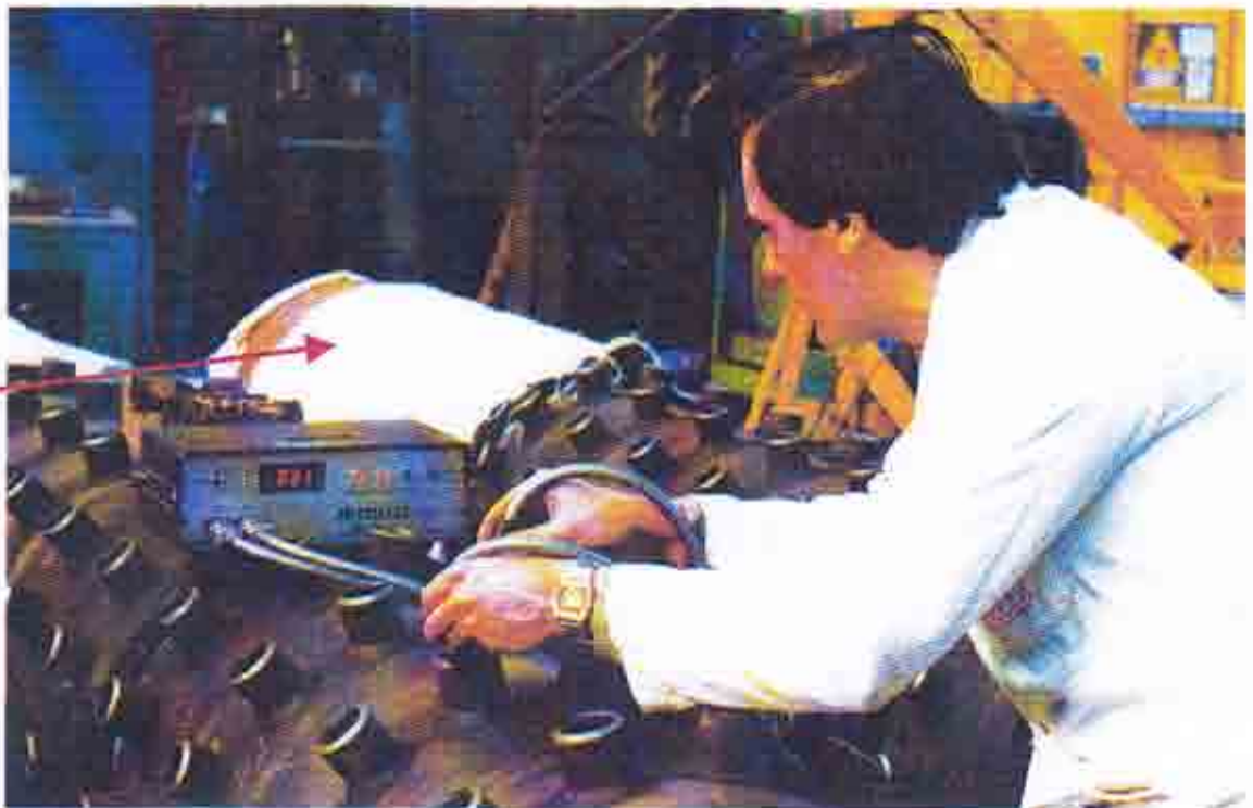
Contrôle de nuance d'acier Inspection of steel grades
