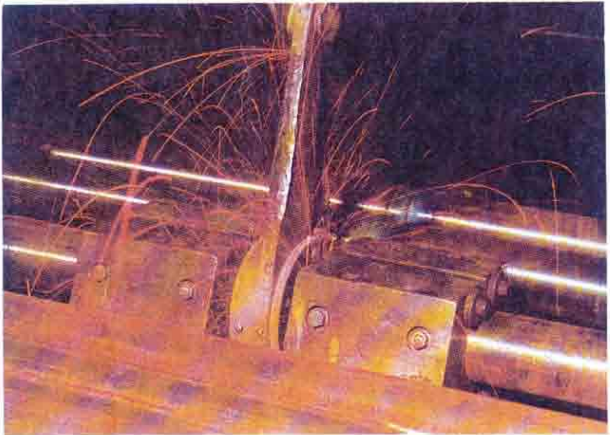
Soudeuse par étincelage pour rabouter les tubes (jusqu'à diamètre 89 mm - épaisseur 8 mm) Flash butt welding machine for tubes (up to diameter 89 mm and thickness 8 mm)
